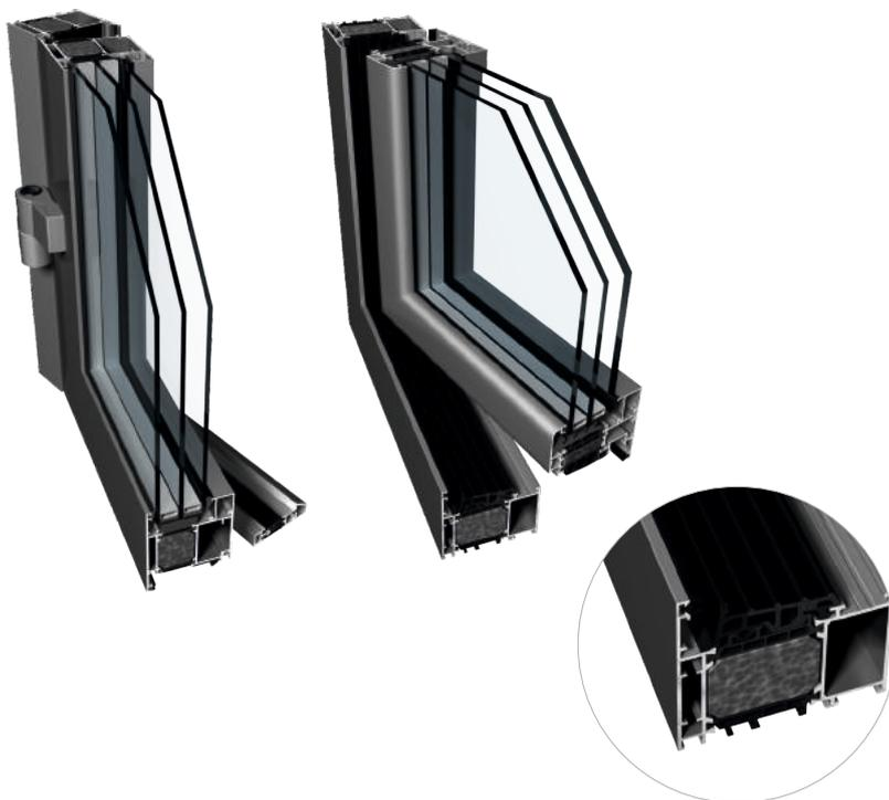
Die HI-Version (mit dem Einsatz aus Aerogel) ermöglicht die Verringerung des Uf-Wertes von 1,1 auf 0,9 W/m<sup>2</sup>K
