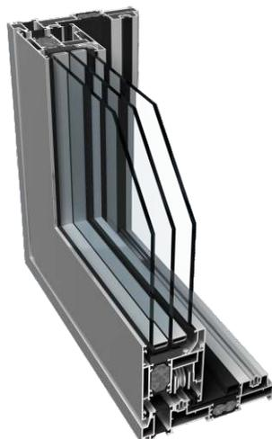
Questo sistema scorrevole tecnicamente molto evoluto permette di creare costruzioni di grandi dimensioni. La dimensione del profilo ci permette di collegare fino a 6 ante da 400 kg ciascuna. L'ampio profilo garantisce la possibilità di realizzare ante con larghezza massima di 3,3 m e 3,4 m di altezza.
