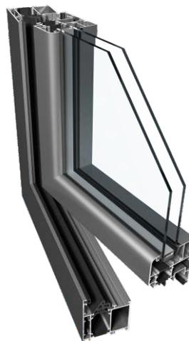
Il sistema PE 78EI è progettato per costruire pareti antincendio in ambienti interni ed esterni. Consente di creare sia le porte con un'anta che quelle a due ante con apertura verso l'esterno o verso l'interno, soglia di varie tipologie. Il sistema utilizza inserti termici con larghezza di 35 mm. La profondità del telaio e dell'anta - 78 mm.
