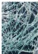
Les vitrages dans le pack sont attachés par un film protecteur qui, en cas de bris, retient les éclats et élimine le risque de blessure. En outre, le film rend difficile le bris du verre en cas d'effraction.
